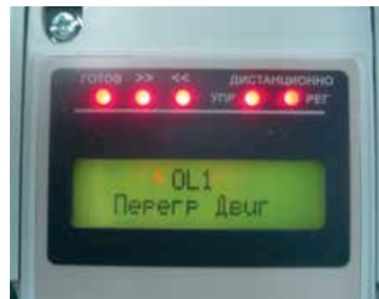
Рис. 2. Сообщение на дисплее преобразователя частоты EI-7011 при токовой перегрузке управляемого электродвигателя.
