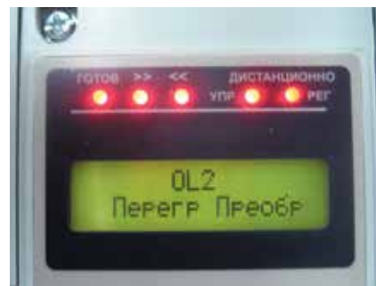
Рис. 3. Сообщение на дисплее EI-7011 при токовой перегрузке преобразователя.
