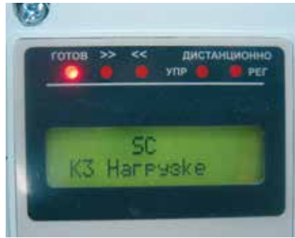
Рис. 4. Сообщение на дисплее EI-7011 при коротком замыкании в нагрузке.
